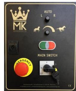
Usamos 3 correias de transmissão, para maior tração. Com cobertura para proteger motor e sistema de transmissão. Caixa de controlo com 3 modos, esquerda, direita e automático; velocidade variável; Botão de emergência.
